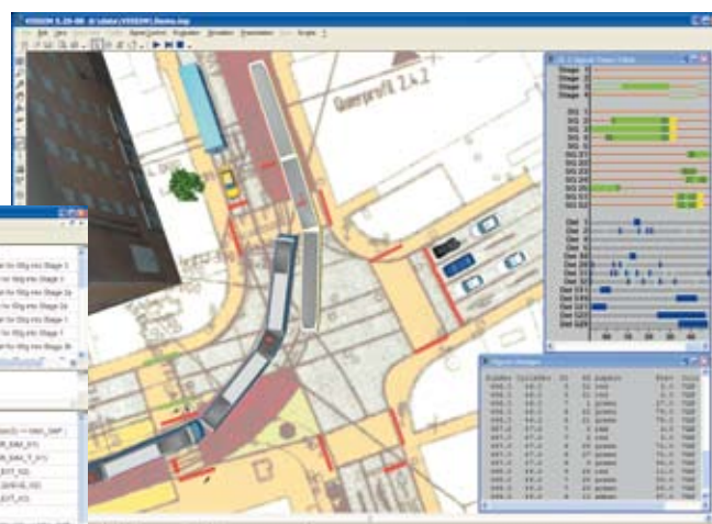
ÖPNV Priorisierung und dynamische LSA Steuerung
